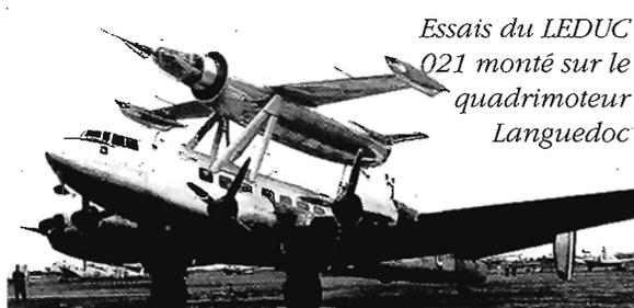
Essais du LEDUC 021 monté sur le quadrimoteur Languedoc
